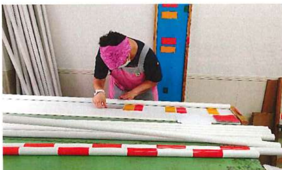
工事関係の場所などで使われる三角コーンの間に使用するバー。進入を禁止したり、境界を示す
